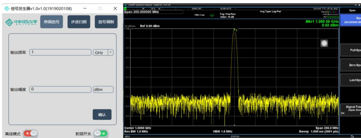
图 8. 单频连续波信号设置与输出结果
